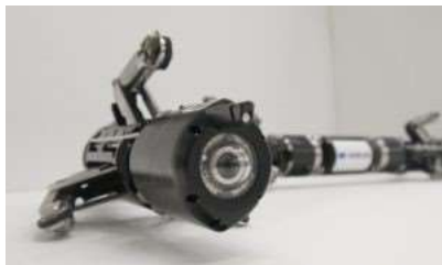
Figura 7.19 - Robot autonom de inspecție (poreclit SubMerged) proiectat de un consorțiu de companii de apă potabilă Vitens, Evides & Brabant Water și Demcon Mechatronics din Olanda
